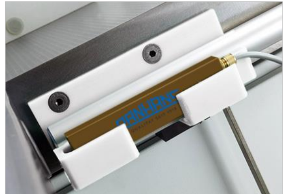
Figur 22: Opbevaringsrum til stiftnøgle
