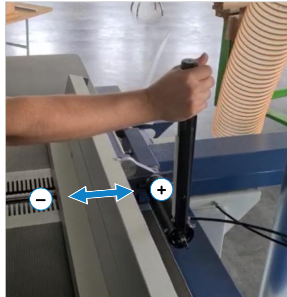
Figur 20: Juster afretteranslaget lineært
