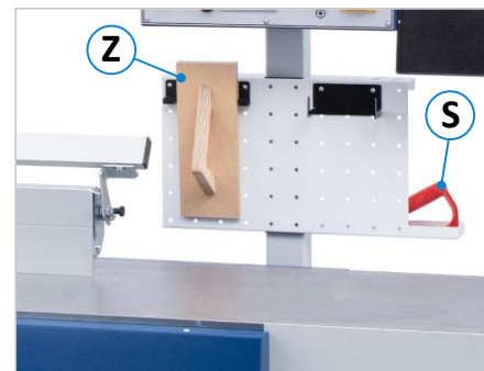
Figur 24: Skyveblokk og skyvehåndtak
