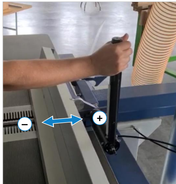
Figur 20: Justera hyvelanslaget linjärt
