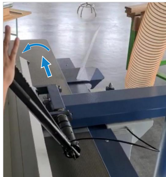
Figur 22: Ställ in vinkeln på hyvelanslaget
