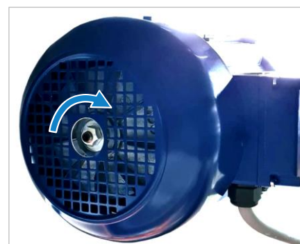
Figur 61: Justering af motorbremsen
