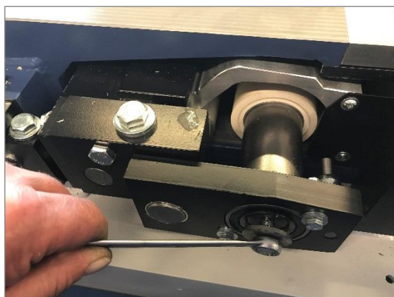
Figur 66: Udskiftning af gummiruller - trin 2
