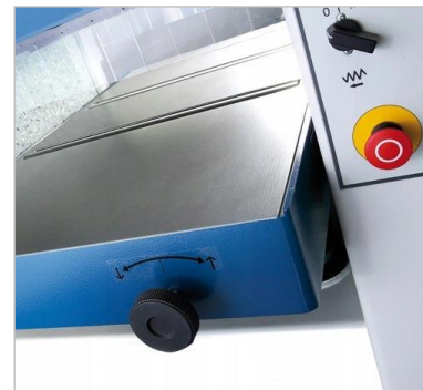
Figur 48: Justering af sengerullerne
