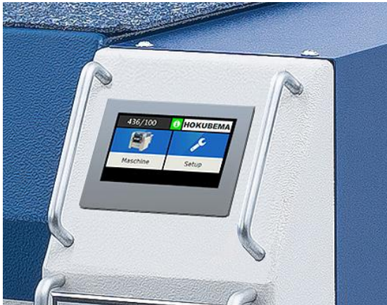
Figur 23: Positioneringskontrol med touchscreen
