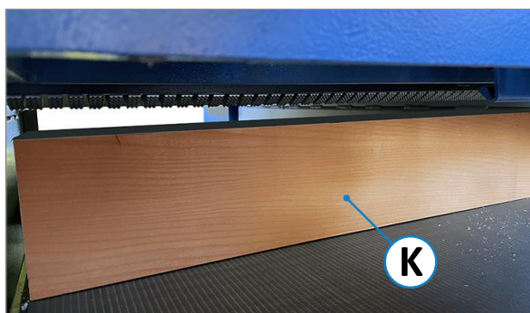
Figur 63: Kvadreret træ som hjælp til justering
