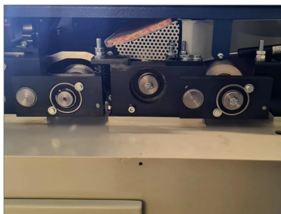
Figur 65: Udskiftning af gummiruller - trin 1b
