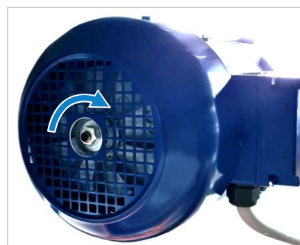
Figur 61: Justering av motorbremsen
