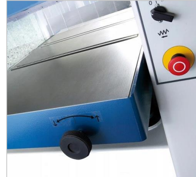
Figur 48: Justering av bordrullene
