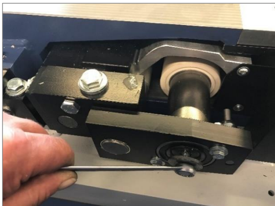
Figur 80: Udskiftning af gummiruller - trin 2
