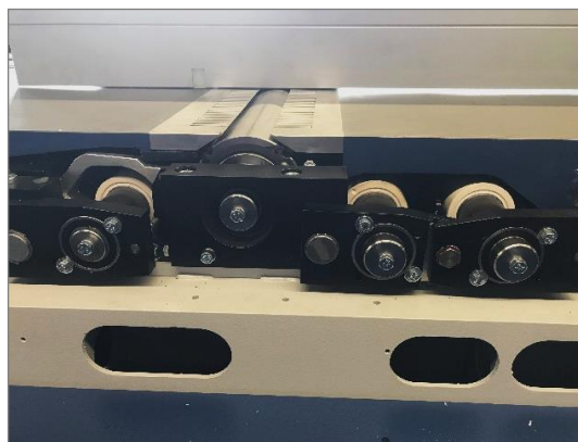
Figur 79: Udskiftning af gummiruller - trin 1b
