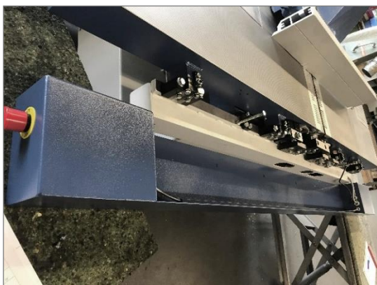
Figur 78: Udskiftning af gummiruller - trin 1a
