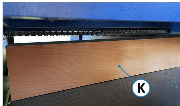
Figur 77: Kvadreret træ som hjælp til justering
