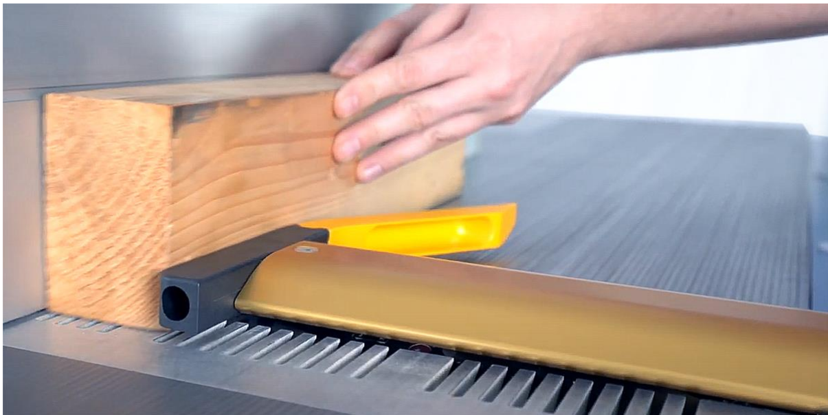
Figur 32: Arbejde med afretterhøvl (eksempel)
