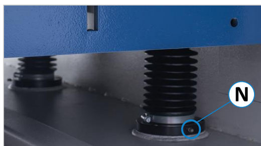
Figur 73: Smørenippel på justeringsspindlerne
