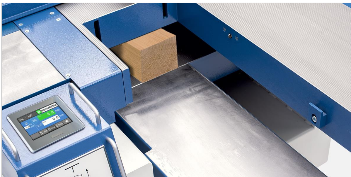
Figur 45: Arbejde med tykkelseshøvlen (eksempel)
