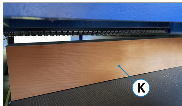
Figur 77: Firkantet tømmer som justeringshjelpemiddel
