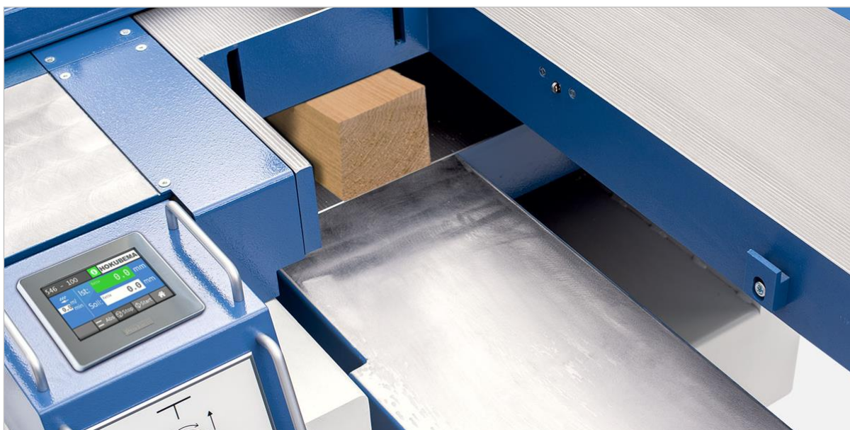
Figur 45: Arbeid på tykkelseshøvelen (eksempel)
