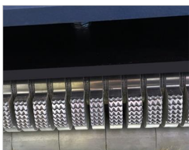
Figur 10: Segment för bakslagshinder
