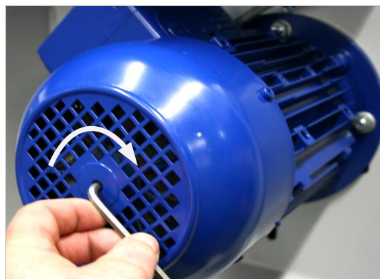
Figur 53: Justering af motorbremsen
