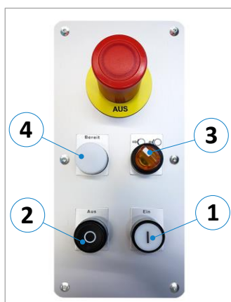
Figur 18: Trykknop-panel 3,0 til 3,5 kW
