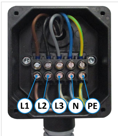
Kuva 14: Kytke 3 vaihetta, nollajohdin ja maadoitus
