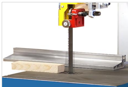
Figur 35: Anslagsskenan ligger platt
