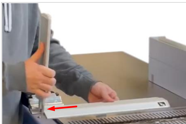
Abbildung 6: Brückenschutz auf Führung aufschieben
