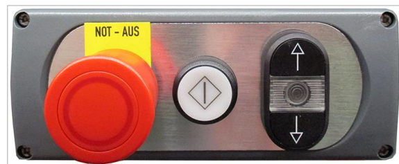
Figure 5 : Commande bimanuelle pour la hauteur
