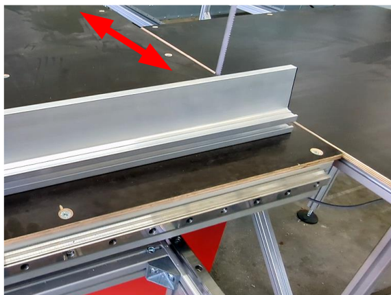
Figure 16 : vérifier l'alignement sur toute la longueur
