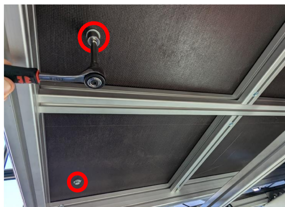
Figure 29 : corriger l'angle de 90° sur la butée transversale
