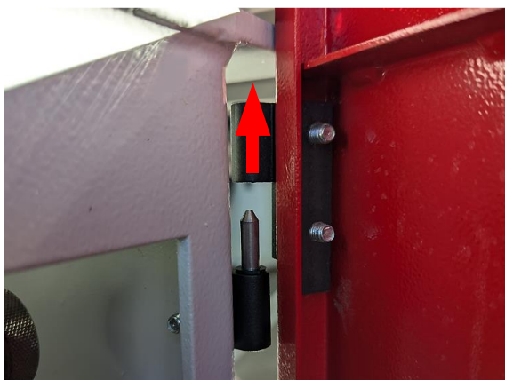
Figure 33 : décrocher la porte inférieure
