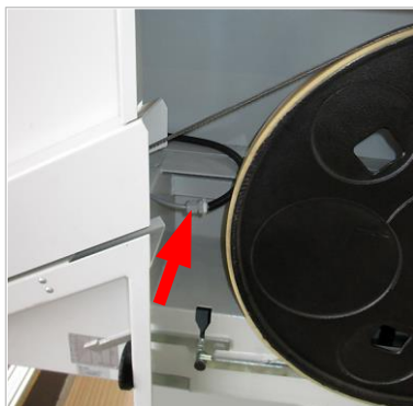
2. Le câble de raccordement avec le presse-étoupe se trouve dans le capot, sur le côté, à côté de la roue supérieure.
