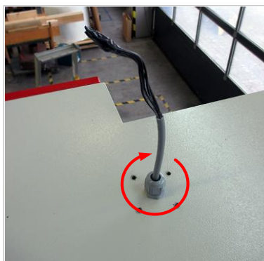
5. Kabelverschraubung oben auf der Haube anziehen.
