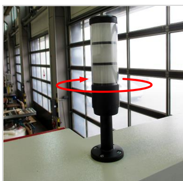
8. Signalsäule auf den Sockel aufsetzen und mit einer kurzen Drehung im Uhrzeigersinn verriegeln (siehe Markierungen auf der Rückseite der Säule).
