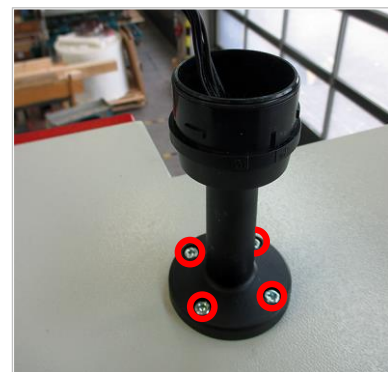
6. Sockel mit 4 Schrauben von oben auf die Haube montieren.
