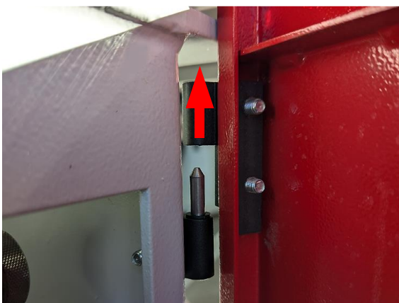
Abbildung 33: Untere Bandsägearadtüre aushängen
