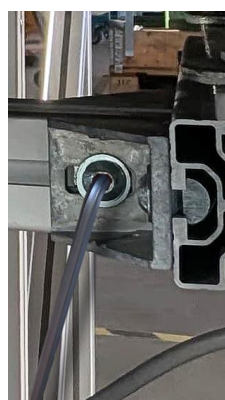
Abbildung 22: Anschlussprofile (A) vorne und hinten an Profil (P) montieren
