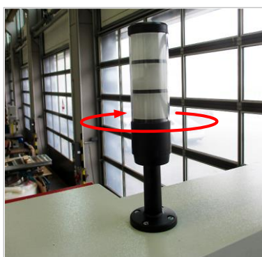
8. Plaats de signaltoren op de sokkel en vergrendel hem met een korte draai met de klok (zie de markeringen op de achterkant van de toren)
