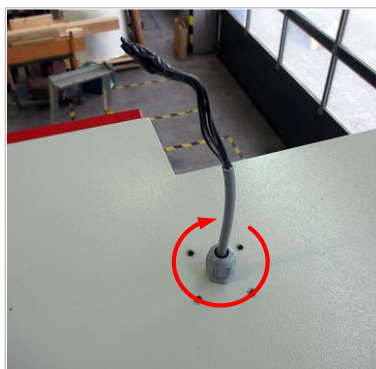
5. Draai de wartel aan de bovenkant van het kapje vast.
