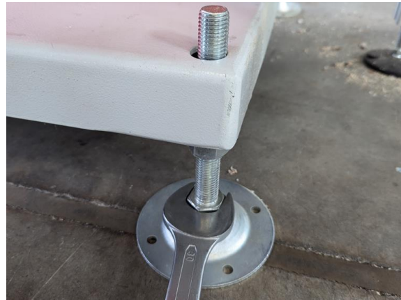
Figuur 4: De machine nivelleren
