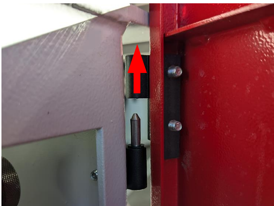
Figuur 33: De onderste lintzaagdeur losmaken
