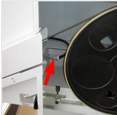
2. De aansluitkabel met wartel bevindt zich in de kap aan de kant naast het bovenste lintzaagwiel.
