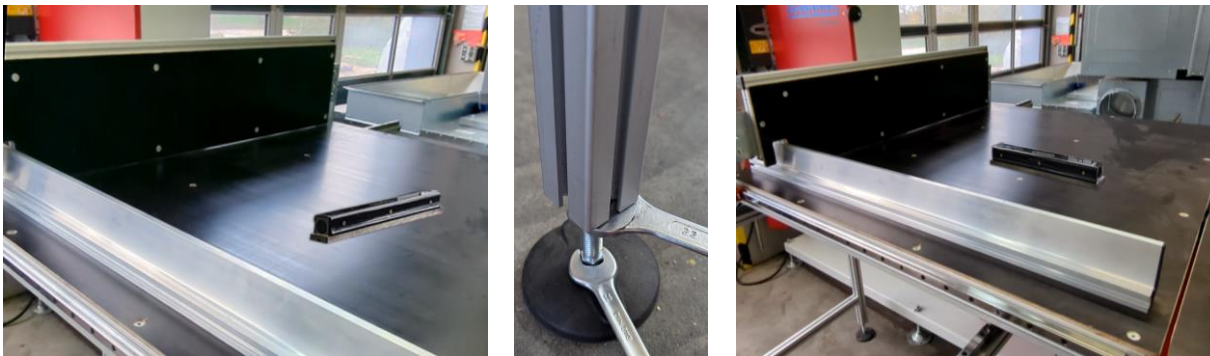
Figuur 18: De schuiftafel nivelleren
