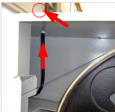
4. Voer de kabel door de kabelwartel.
